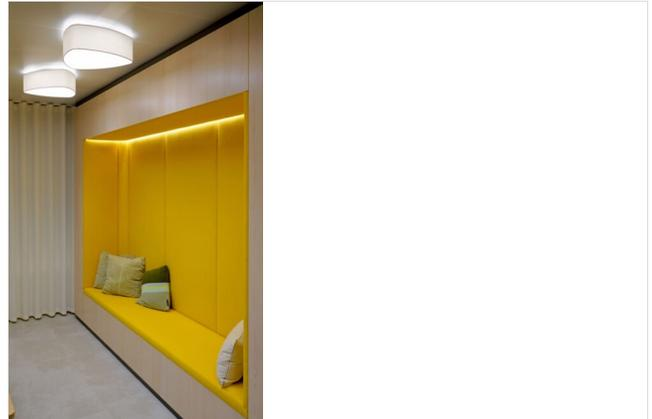
**5** Das LED-Licht der energieeffizienten x.textil mit 3800 Lumen ist absolut flimmerfrei und besitzt einen hohen Farbwiedergabewert (CRI > 90). Die Produktionstechniker von luxwerk haben die Leuchte so entwickelt, dass sie zum Direktlicht eine angenehme indirekte Lichtaura an die Decke zeichnet. Foto: luxwerk
