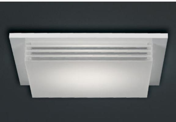
Quadratisches Deckeneinbaudownlight mit kantigem Abdeckrahmen aus Aluminiumdruckguss. Oberfläche pulverbeschichtet in Weiß RAL9003 glänzend. In den Abdeckrahmen ist ein quadratischer Acrylglas-Block (QC-Element) eingehängt, der das Downlight optisch aufwertet. Der Acrylglas-Block mit klaren, hochglanzpolierten Außenkanten und satiniertes Unterseite scheint als leuchtende Scheibe unter der Decke zu schweben.
